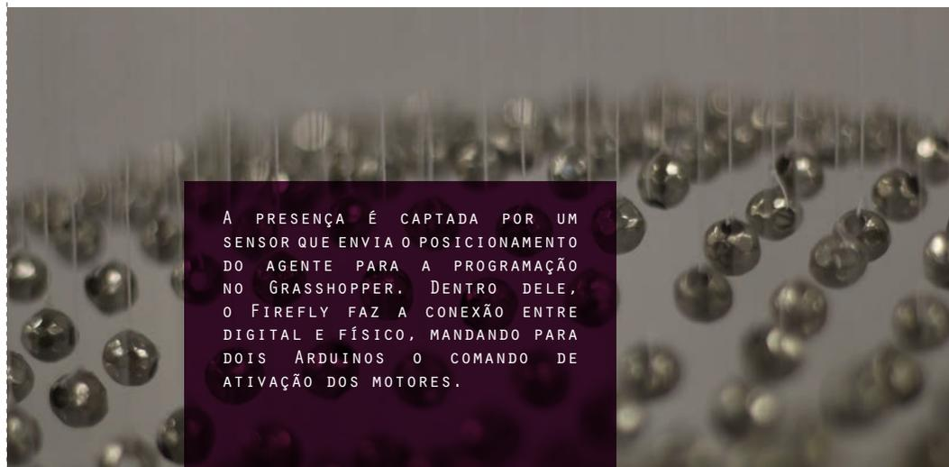
A PRESENÇA É CAPTADA POR UM SENSOR QUE ENVIA O POSICIONAMENTO DO AGENTE PARA A PROGRAMAÇÃO NO GRASSHOPPER. DENTRO DELE, O FIREFLY FAZ A CONEXÃO ENTRE DIGITAL E FÍSICO, MANDANDO PARA DOIS ARDUINOS O COMANDO DE ATIVAÇÃO DOS MOTORES.
