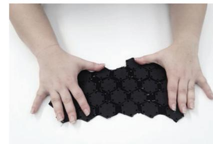
TESTES DE MATERIAS E DE PARTIDOS GEOMÉTRICOS PARA A ESCOLHA DE UMA MALHA ELÁSTICA E RESISTENTE.
