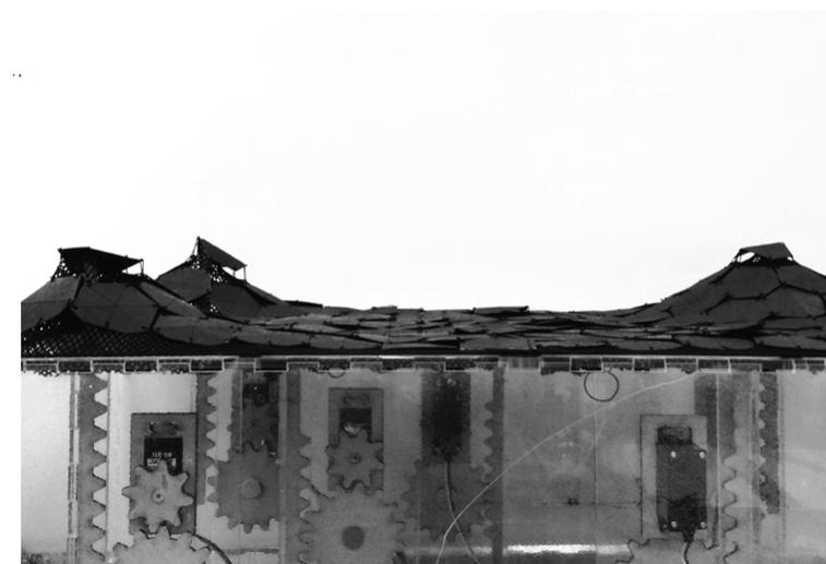
Dentre os mecanismos de funcionamento possíveis foi adotada a engrenagem, que passou por remodelações até alcançar seu máximo potencial de subida para o torque do motor servo disponível.
